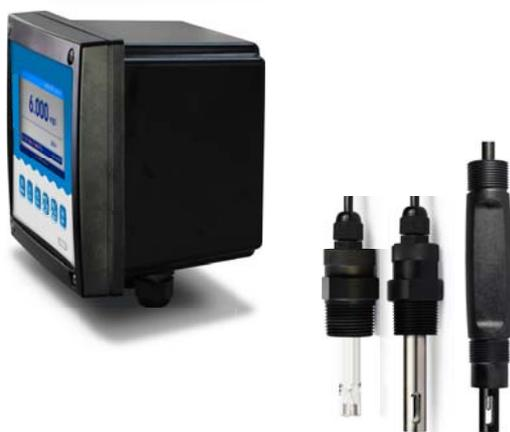
在線導電率儀是帶微處理器的水質在線監測控制儀。該儀表配置不同常數的電導電極廣泛用於電廠、石油化工、冶金電子、礦業、紙業、半導體、醫藥、食品飲料、環保水處理、新型農業種植等各個行業；適用於軟化水、原水、蒸汽冷凝水、海水蒸餾以及去離子水等；對水溶液的導電率、鹽度、TDS和溫度值進行連續監測和控制。
